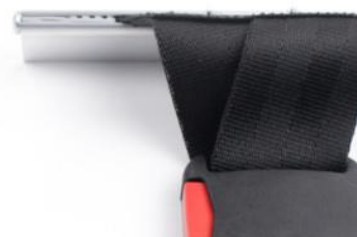
2. Dübel ganz einschieben und verschrauben
